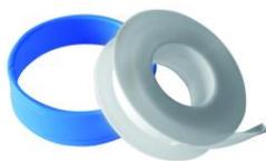
**Remarque :** Dans le cadre d'une installation en basse pression, il n'est pas nécessaire de coller les éléments entre eux. Un simple assemblage avec du téflon suffit à garantir l'étanchéité, sans risque de contamination pour les poissons ou les plantes. Cette méthode offre également la possibilité de démonter facilement les composants en cas de modification du système.
